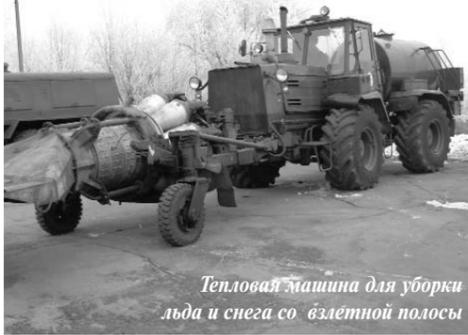
Тепловая машина для уборки льда и снега со взлетной полосы
